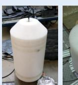
直径21cm、36cmの ポリエチレン 高速中性子を減速 し、3He比例計数管 で測定しやすくする
